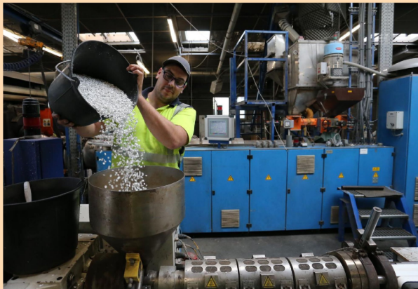
Janine teste le PVC entré dans l'extrudeuse de laboratoire pour vérifier sa conformité. Janine est « jumper », un terme péjoratif capable de passer d'un poste à un autre. Photo: Lucien PÉTIOT
