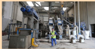
Le vieu profilé PVC, usagé et cassé, broyé, décaoutché avant d'être calibré, dépoissé et isolé des autres matériaux (verre, bois et caoutchouc). Ainsi broyé et propre, le PVC sera ensuite extrudé dans un gros four pour être fondu et filtré. Il ressort en longues tablettes qui seront découpées en lentilles ou granulés avant d'être emballés dans des « big bags » de 12 tonnes. Chaque « big bag » de 1,2 tonne subit un double contrôle de conformité.
